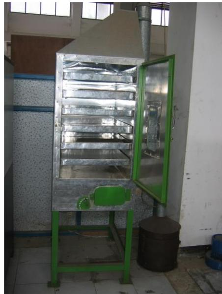
Gambar 1. Pengering Dengan Kontrol Suhu RTD
