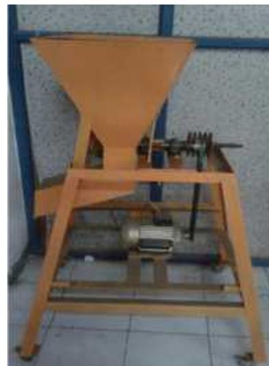
Gambar 4. Hasil rancang bangun mesin pencacah sampah plastik.
