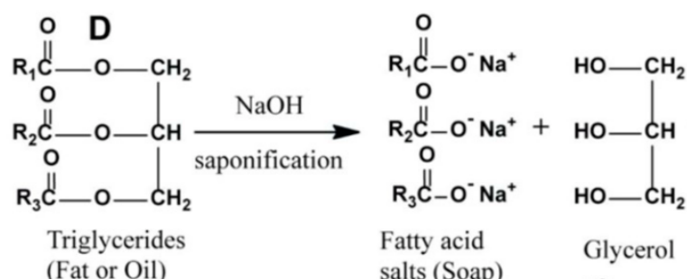
Gambar 4. Reaksi saponifikasi pada proses pembuatan sabun
