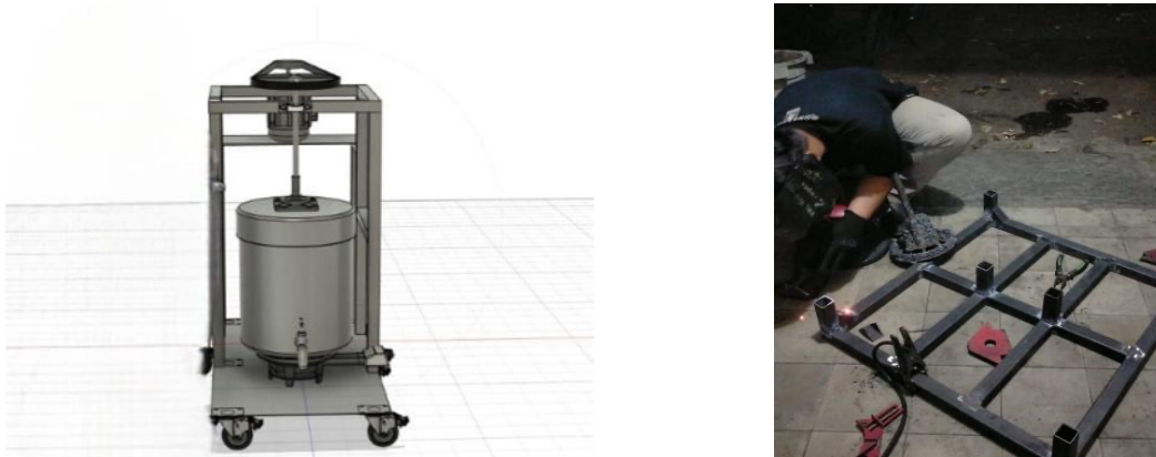
Gambar 3. Desain dan Proses Manufaktur Mesin
