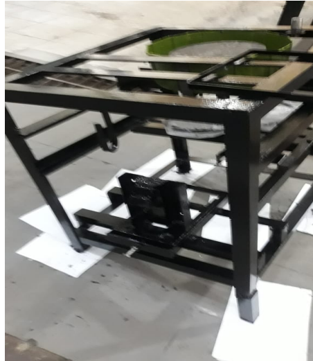
Gambar 2. Pembuatan Mesin Dimulai dengan pembuatan sasis (Rangka) Dengan Bahan Besi Siku 5 Cm x 5 cm Tebal 2 mm
