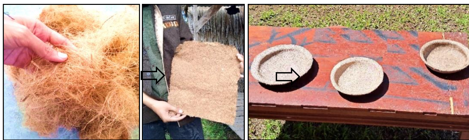
Gambar 6. Pengolahan Serat Sabut Kelapa Menjadi Produk Piring
