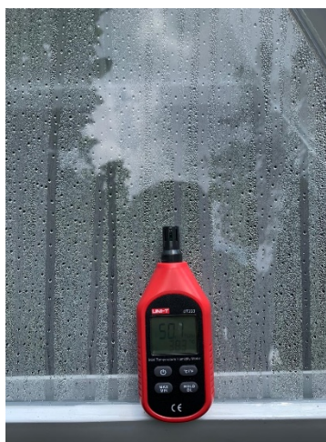
Gambar 3. Hasil Kondensasi Prototipe Solar Still dan Monitoring Suhu dan Kelembaban Selama Proses Berjalan
