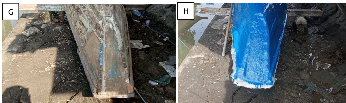
Gambar 6. Kegiatan Pelatihan Laminasi Kapal, Keterangan: A. Penyerahan Bantuan Bahan dan Alat untuk Laminasi, B. Pengukuran permukaan lambung kapal, C. Pemotongan serat mat dan roving, D. Pencampuran resin dan katalis (perbandingan 1:1), E. Pelapisan kapal dengan larutan campuran resin dan katalis dengan serat mat dan roving, F. Hasil setelah proses pelapisan selesai, G. Foto kapal sebelum dilaminasi, H. Foto kapal sesudah dilaminasi.
