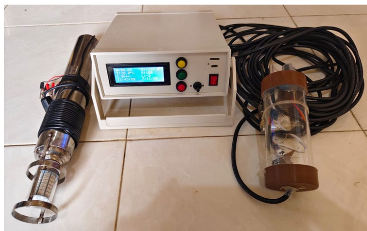
Gambar 4. Tampilan UFL+ secara utuh (Lampu yang dilengkapi sensor oseanografi terintegrasi)
