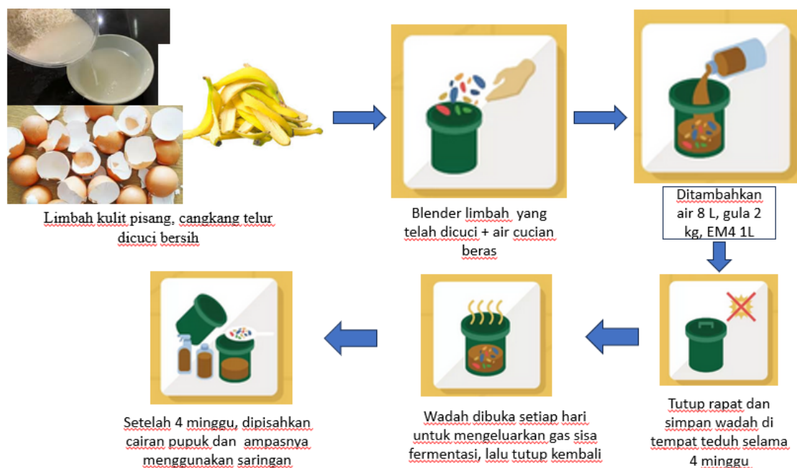
Gambar 2. Penerapan IPTEK dalam Teknologi Pembuatan POC Kombinasi Limbah Cangkang Telur, Kulit Pisang, Dan Air Cucian Beras
