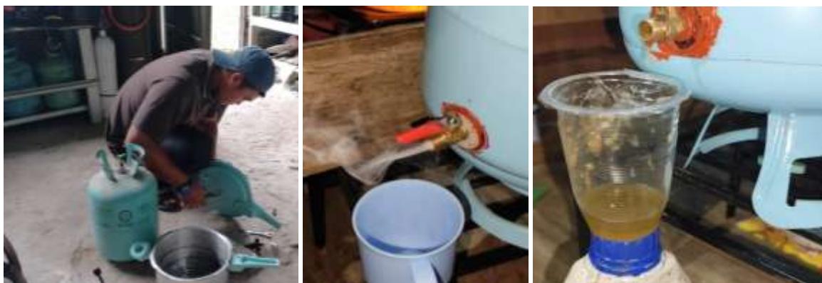
Gambar 2. Proses pembuatan alat pirolisis sederhana; Proses pemanasan alat dan hasil pirolisis
