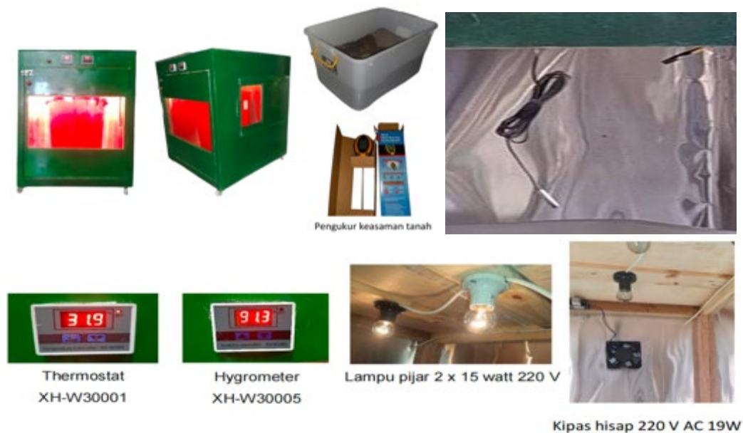
Gambar 2. Komponen Penyusun Inkubator Alat bantu Penetasan Telur Penyu
