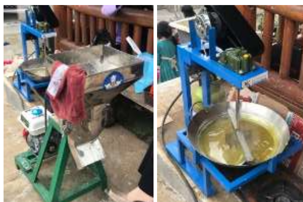
Gambar 8. Proses produksi jamu instan menggunakan mesin pengolahan otomatis.
