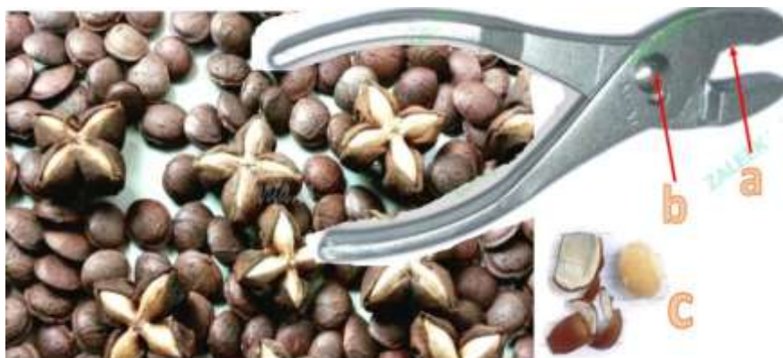
Gambar 1. Kancip pemecah kulit biji kacang Sacha Inchi; (a) gerigi pemegang kacang; (b) lubang penyesuaian ukuran biji; (c) biji bebas kulit
