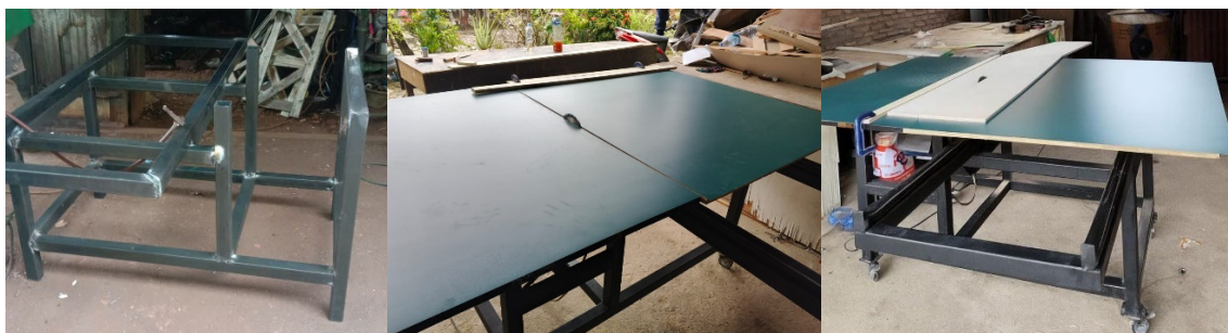
Gambar 6. Proses Rancang Bangun Alat Meja Potong Serbaguna
