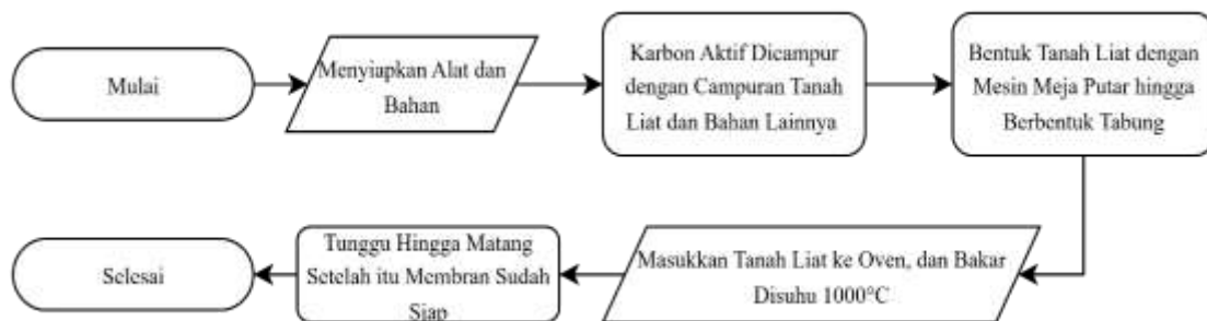
Gambar 6. Alur Pembuatan Membran Keramik
