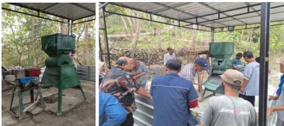
Gambar 3. Mesin pencacah batuan (kiri) dan pelatihan operasional mesin produksi pasir kucing dari zeolit alam
