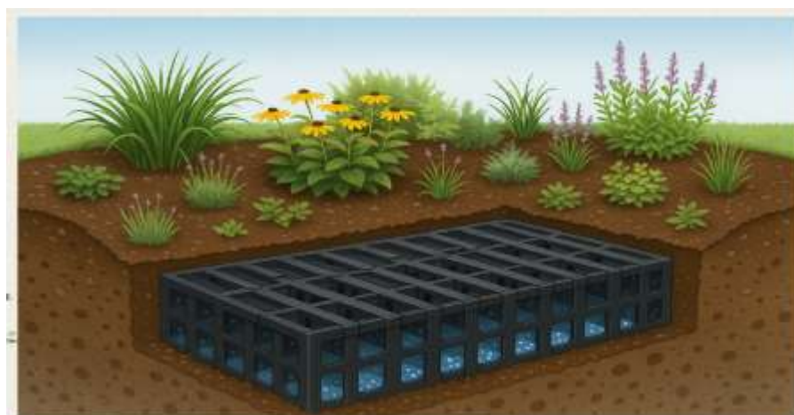
Gambar 4. Konsep Teknologi Rain Garden di SD Daar El Salam
