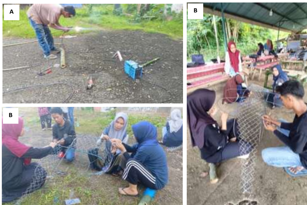
Gambar 3. A. Perakitan kerangka atraktor cumi-cumi menggunakan las. B. Penjahitan kawat harmoni pada kerangka atraktor yang sudah siap.
