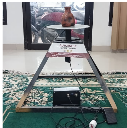
Gambar 5. Penggabungan alat pemutar dengan rangkaian
