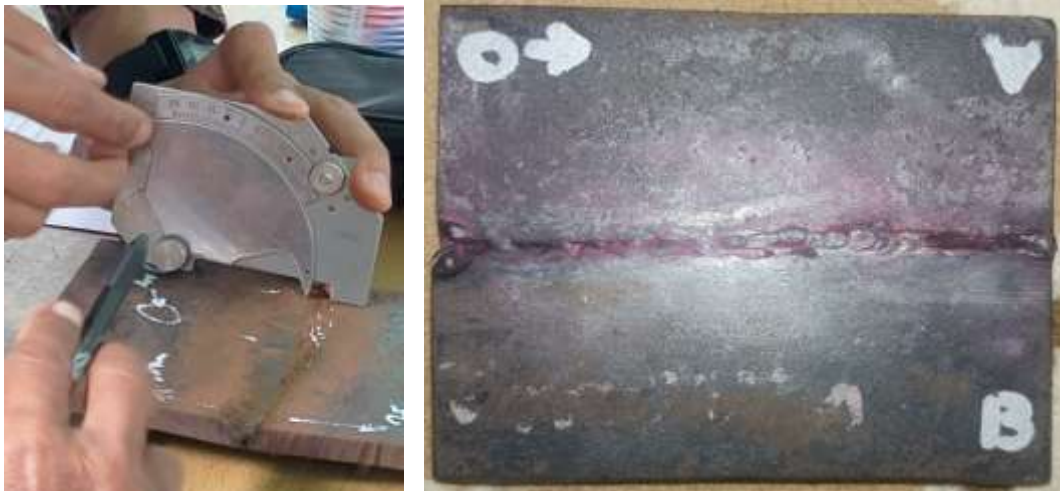
Gambar 3. Kegiatan Praktik Pemeriksaan Visual dan NDT Hasil Pengelasan
