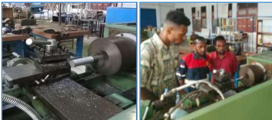
Gambar 4. (a) Memasang benda kerja pada chuck; (b) Mengatur kecepatan putar
