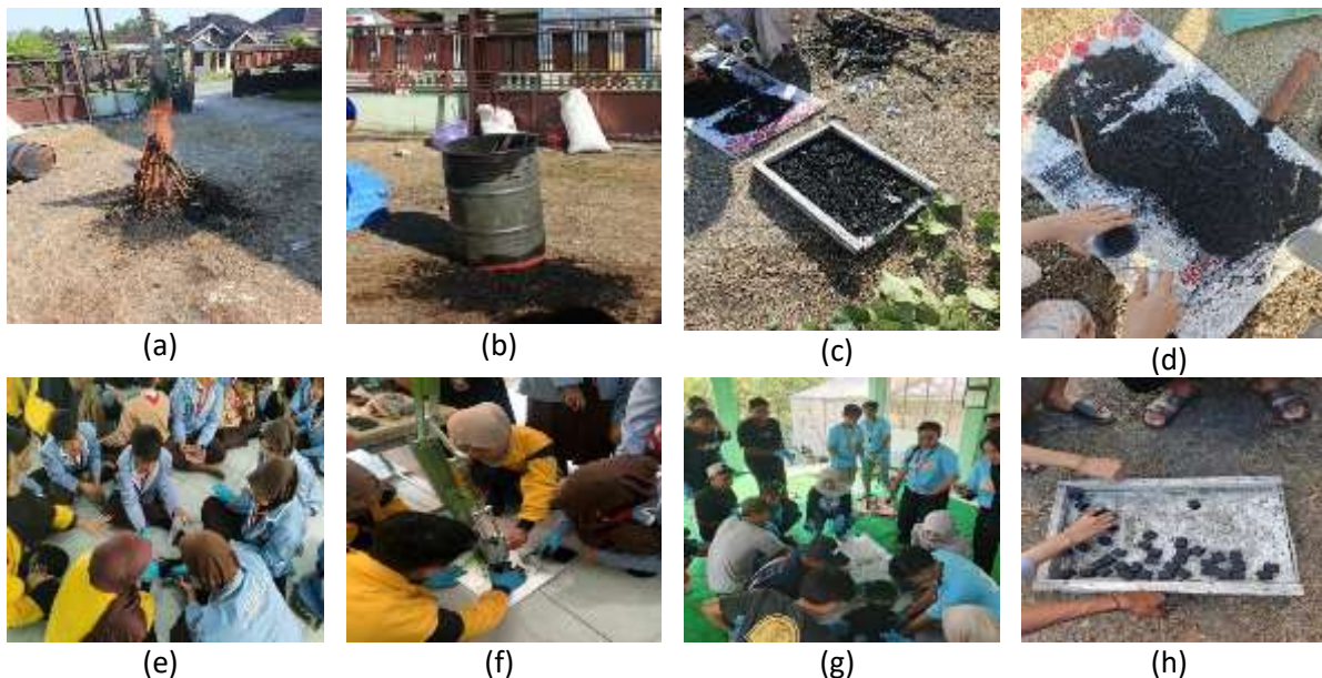
Gambar 5. Kegiatan Praktik Pembuatan Briket: a). Proses Pembakaran Limbah Ranting dan Daun Belimbing; b). Tempurung Kelapa yang sudah dibersihkan dimasukkan kedalam drum pembakar; c). Hasil Pembakaran Daun Kering, Ranting dan Tempurung Kelapa; d). Proses Penghalusan Hasil Pembakaran; e). Praktik Pembuatan Adonan Briket Bersama Siswa SMP; f). Proses Pengepresan Adonan; g). Praktik Pembuatan Briket Bersama Masyarakat Desa; h). Proses Penjemuran Briket.
