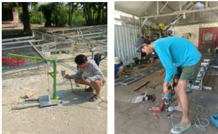
Gambar 3. Pembuatan Alat Pencetak Briket
