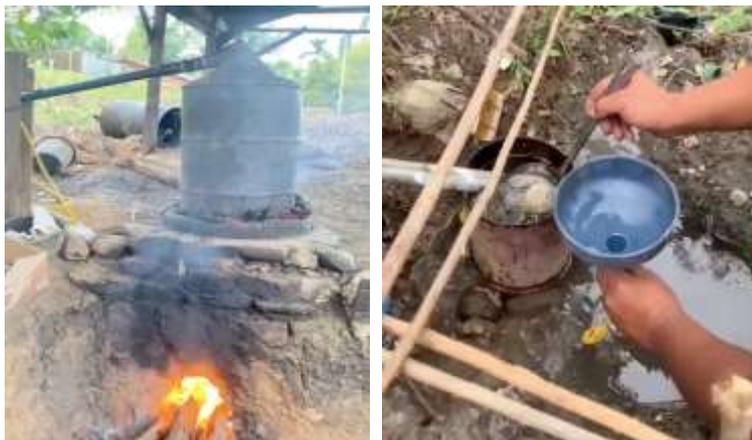
**Gambar 2. Proses perebusan tanaman serai dan pengambilan minyak serai setelah proses perebusan**
