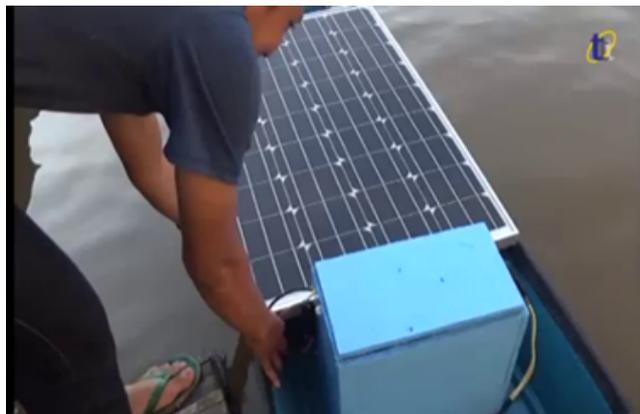
Gambar 1. Perahu listrik prototipe Universitas Tanjungpura dengan sistem fotovoltaik.
