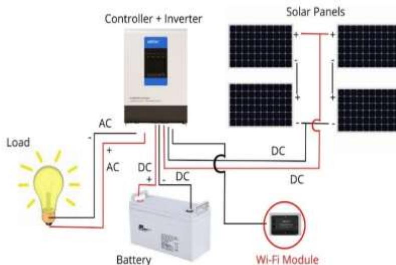
Gambar 3. Skema PV Sistem Berbasis IOT
