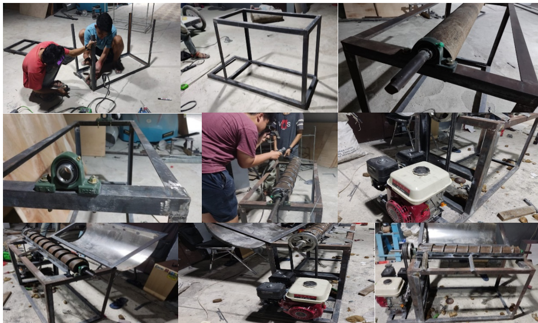
Gambar 3. Proses Perakitan Mesin Pengupas Kulit Buah Pinang Kering
