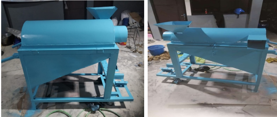
Gambar 4. Mesin Pengupas Kulit Buah Pinang Kering
