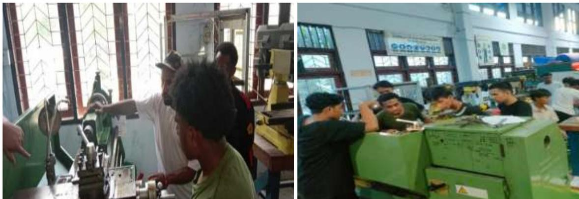
Gambar 4. Praktik pembubutan menggunakan insert
