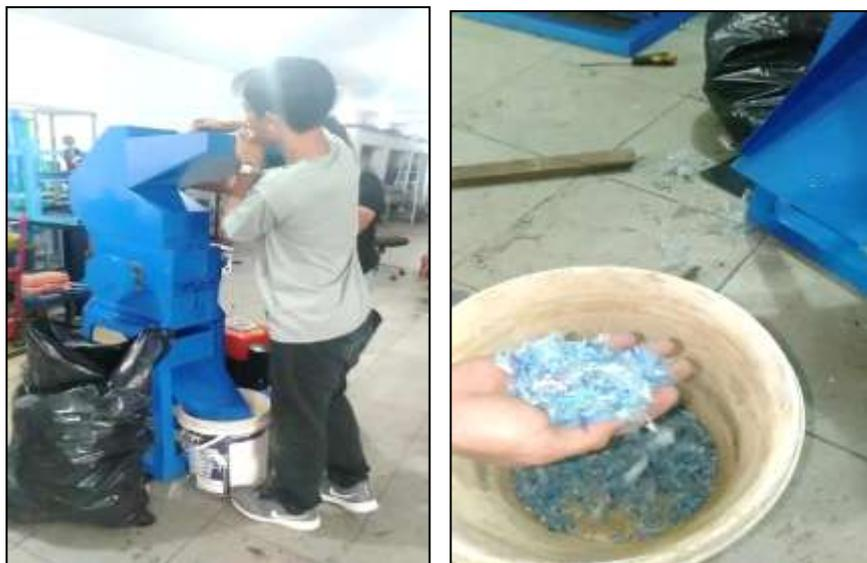
Gambar 4. Proses Ujicoba Mesin Pencacah Plastik
