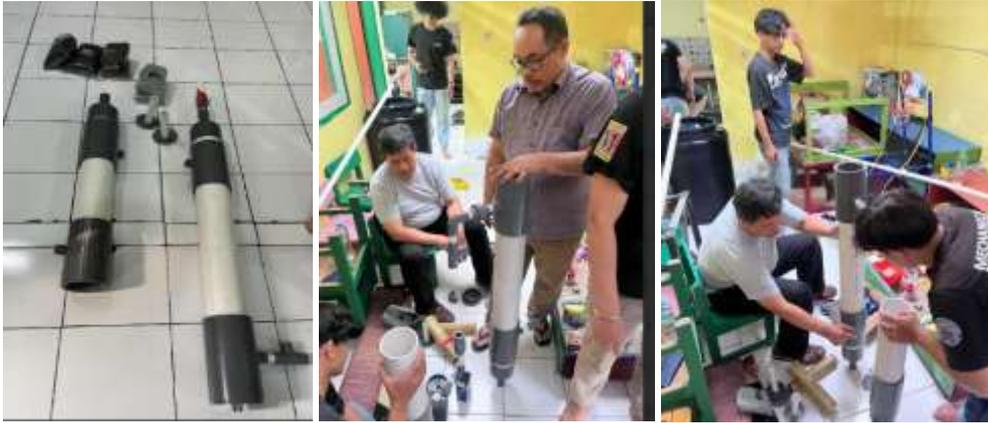
Gambar 3. Pemasangan filtrasi air
