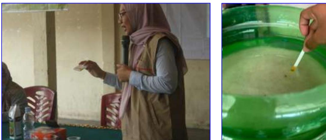
Gambar 7. Pengukuran pH air setelah dilakukan filtrasi dengan kertas lakmus
