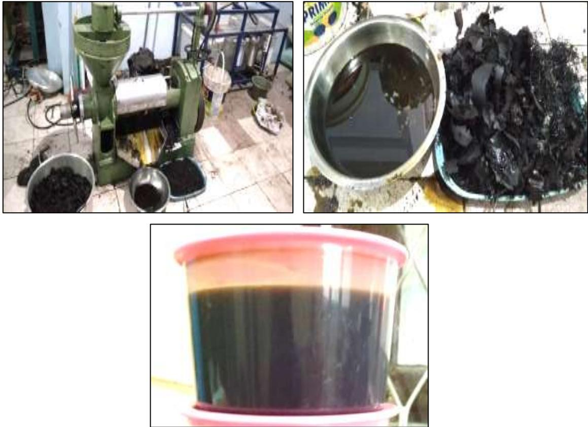
Gambar 9. Proses Pengepresan Minyak Tengkawang
