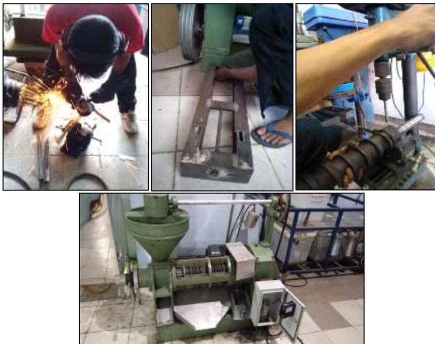
Gambar 7. Proses Pembuatan Mesin Pengepres Berulir Tunggal
