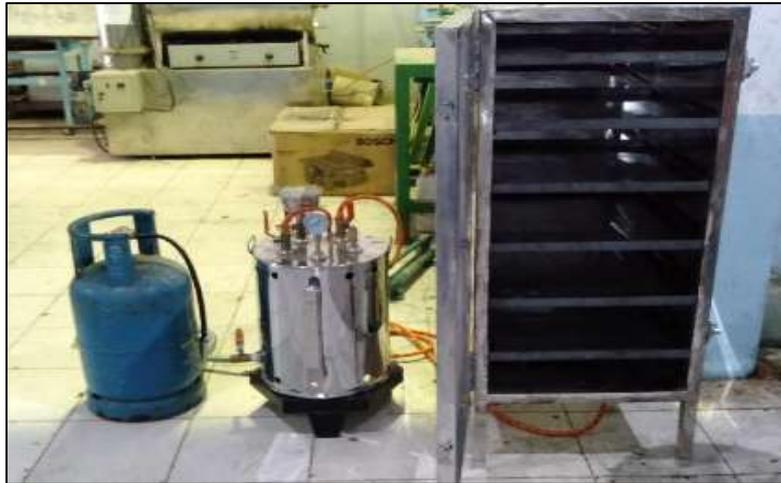
Gambar 6. Rangkaian Alat Pengukusan
