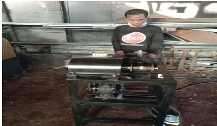
Gambar 3. Mesin sudah jadi dibuat tetapi belum dicat dan dicoba awal oleh mitra pengguna untuk memastikan mesin bisa berfungsi dengan baik .
