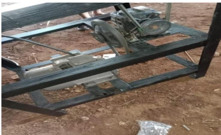
Gambar 2. Pembuatan mesin dimulai dengan pembuatan sasis (rangka)
