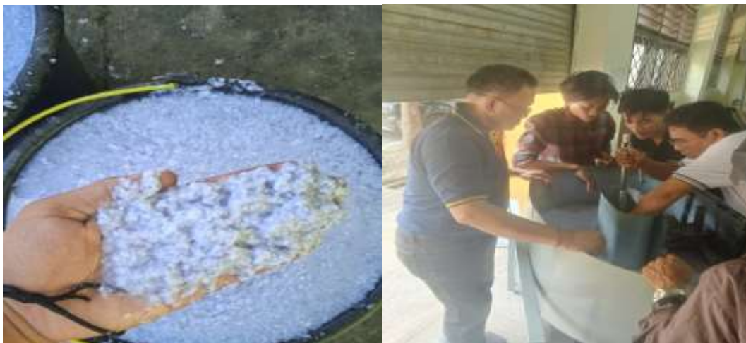
Gambar 1. Proses Pembuatan bubur kertas bekas (tradisional/manual dan dengan mesin)
