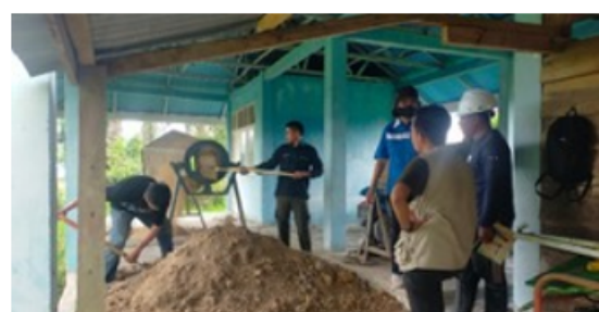
Gambar 7. Proses Pencampuran, Pengayakan Bahan Pembuatan Pupuk Bokashi Menggunakan Mesin, dan Pencampuran Larutan Fermentasi (Air, Tetes Tebu, & Bakteri EM4)
