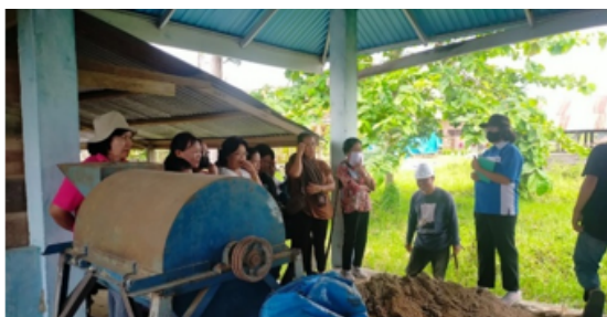
Gambar 7. Proses Pencampuran, Pengayakan Bahan Pembuatan Pupuk Bokashi Menggunakan Mesin, dan Pencampuran Larutan Fermentasi (Air, Tetes Tebu, & Bakteri EM4)
