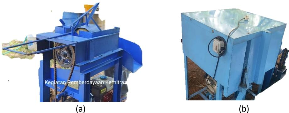
Gambar 3. (a) Mesin pengupas sabut kelapa dan (b) mesin pengupas tempurung kelapa
