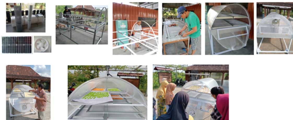
Gambar 2. Rancang bangun alat solar dryer dan penggunaannya dalam pengeringan manisan
