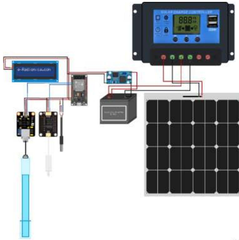
Gambar 5. Wiring diagram system IOT untuk optimasi budidaya tanaman hidroponik
