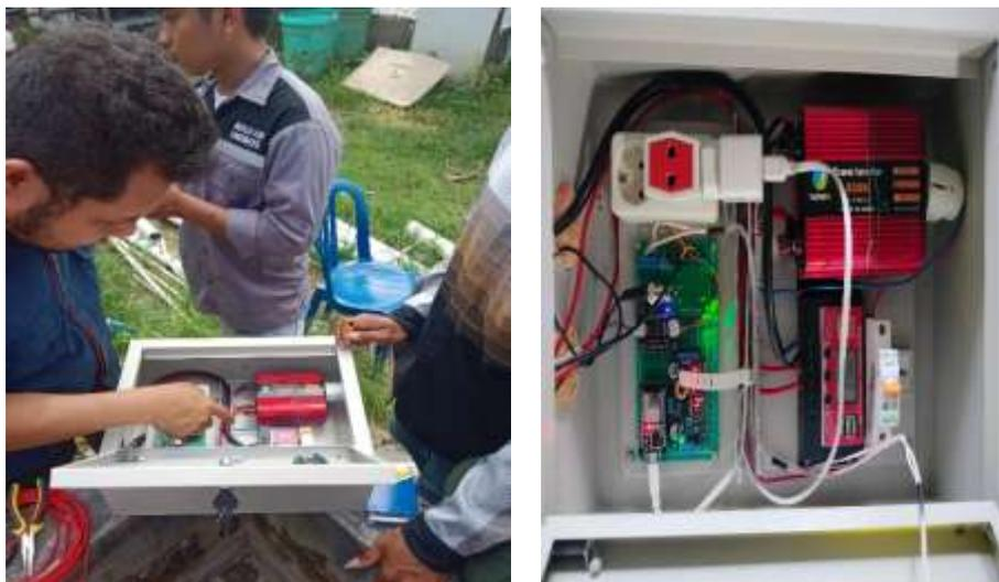
Gambar 6. Pemasangan rangkaian IOT untuk optimasi budidaya tanaman hidroponik
