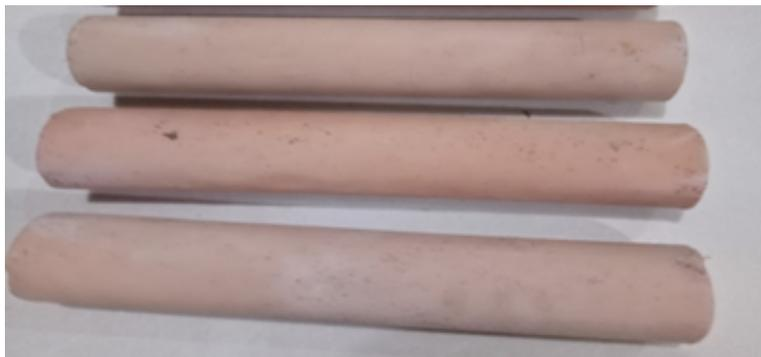
Gambar 1. Membran keramik yang terbuat dari campuran tanah liat, serbuk besi, dan karbon aktif yang dibuat dari tandan kosong kelapa sawit
