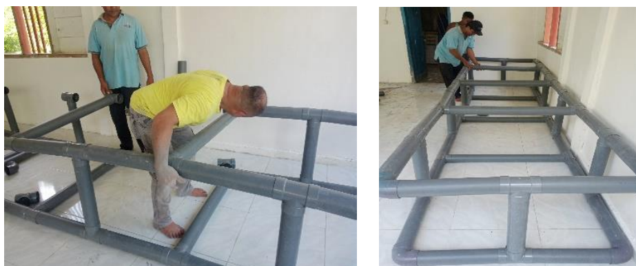
Gambar 3. Pendampingan pembuatan kerangka keramba jaring apung
