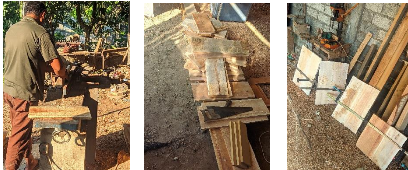
Gambar 2. Proses penghalusan sisi yang akan direkat (kiri), sampel kayu yang siap direkatkan (Tengah), kayu laminasi sesuai ukuran dengan proses clamping
