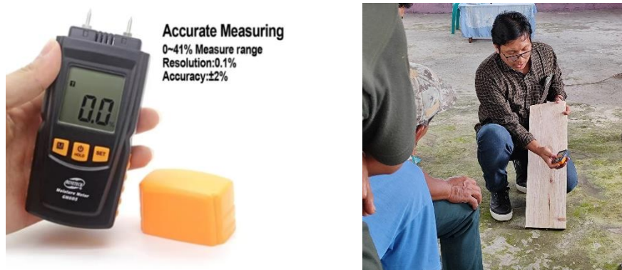
Gambar 1. Alat moisture meter (kiri) dan praktik penggunaannya (kanan)
