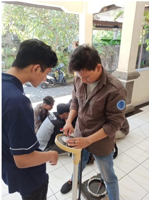
Gambar 3. Perbaikan timbangan dewasa
