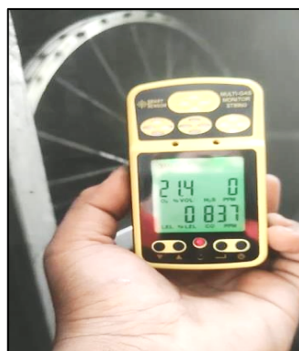
Gambar 6. Pengukuran Kadar Polusi Pada Lemari Pengering dan Pengasapan Ikan
