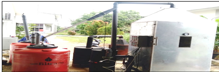
Gambar 3. Alat Multifungsi Pengering dan Pengasapan Ikan Bebas Polusi Udara
