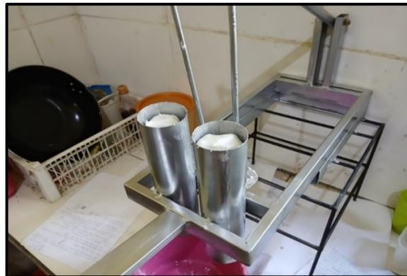
Gambar 2. Pengujian Alat Pencetak Kue Ulat Sutera
