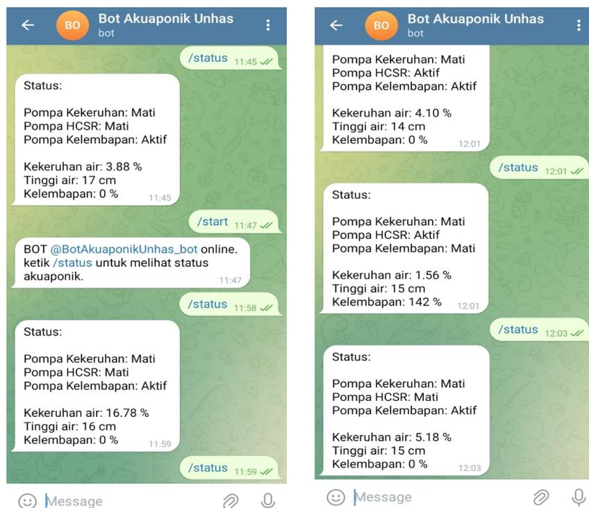
Gambar 8. Hasil demonstrasi pemantauan parameter pada sistem akuaponik melalui telegram
