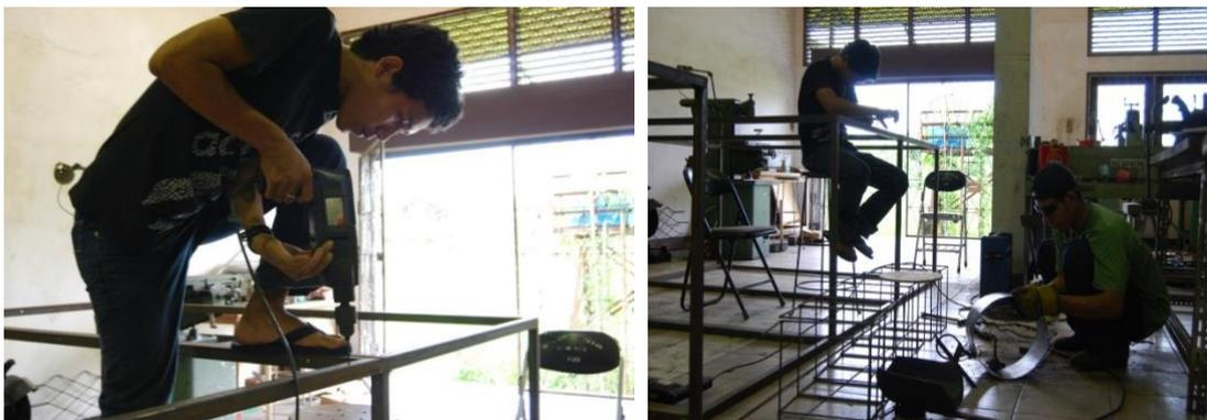
Gambar 1. Proses Pembuatan Kerangka Alat Penyimpan Pisang
