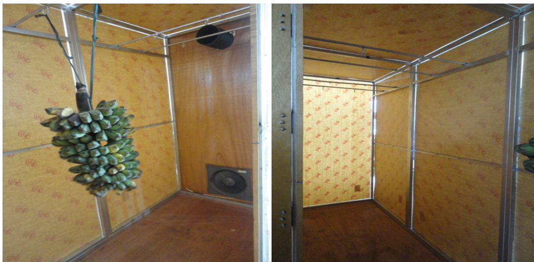
Gambar 5. Bagian Dalam Penyimpanan Pisang Dengan Atmosfir Terkendali
