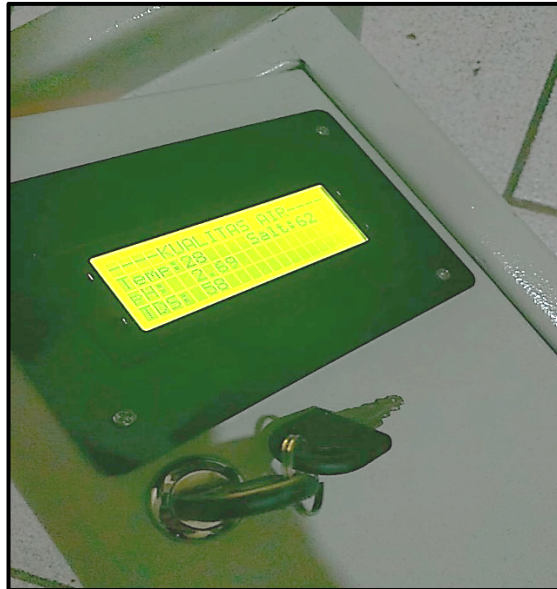
Gambar 3. Desain Dan Prototipe Alat Ukur Kualitas Air Portabel
