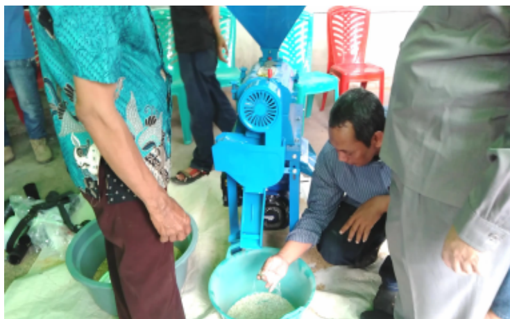
Gambar 1. Uji Coba Penggunaan Mesin Pengupas Gabah
