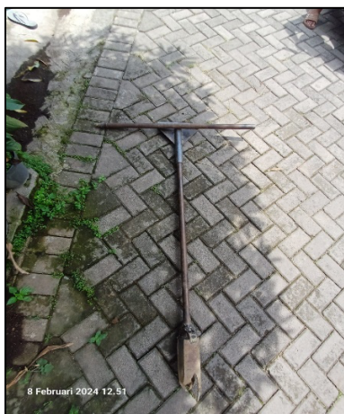
Gambar 3. Bor Biopori Peralatan Utama Yang Digunakan Untuk Menggali Lubang Resapan Bipori
