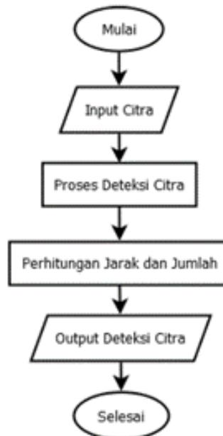
Gambar 4. Flowchart cara kerja program deteksi kerumunan.
